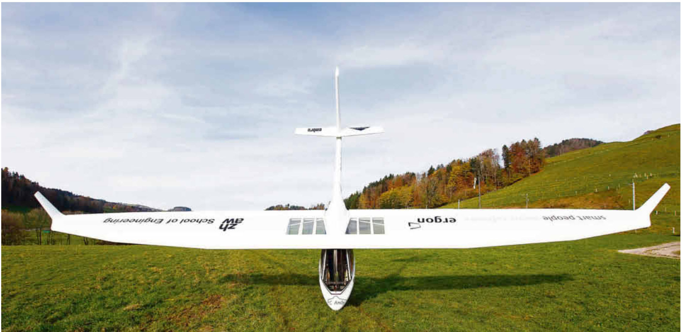
Der Leichtsegler der Firma Ruppert Composite aus Wald zeichnet sich durch sein geringes Gewicht aus: Nur 60 Kilogramm bringt das Flugzeug mit einer Spannweite von gut 13 Metern auf die Waage. Bild: Nicolas Zonvi
