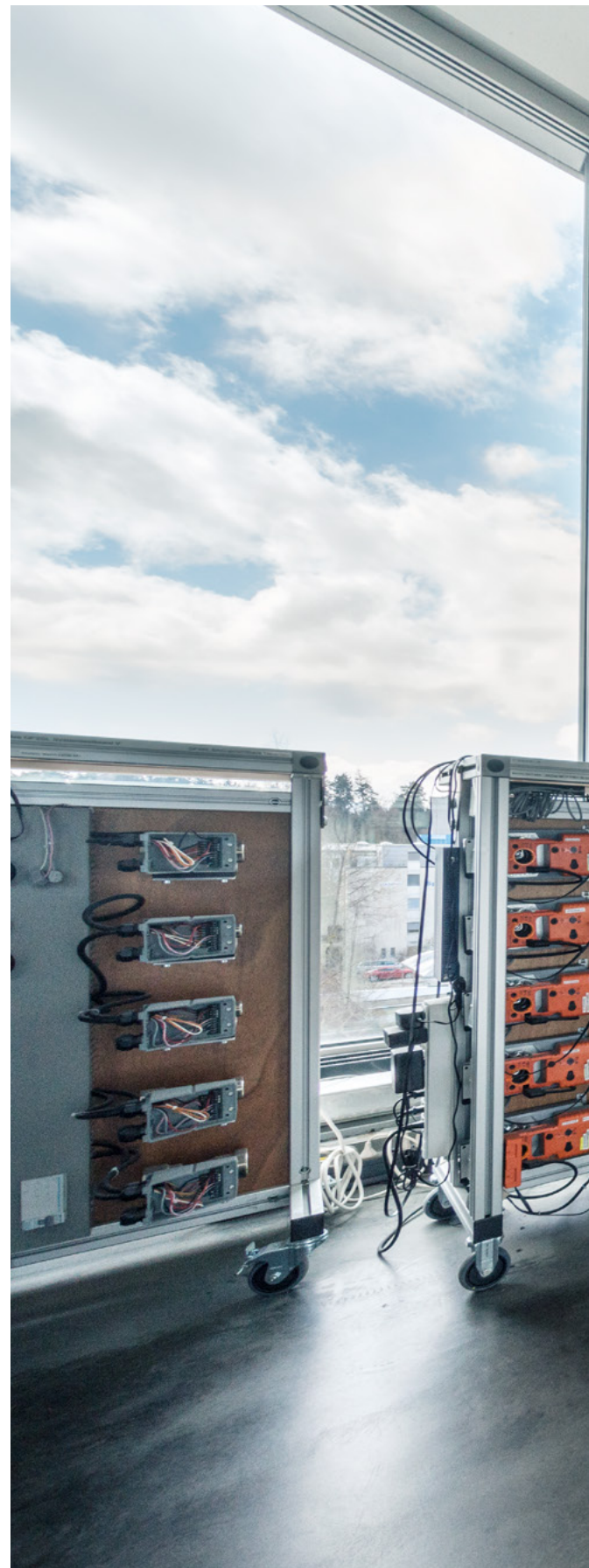
Die Qualität der Belimo-Geräte wird in Langzeittests sichergestellt. Die Geräte werden typischerweise fest verbaut und sind dann 20 Jahre im Einsatz.
