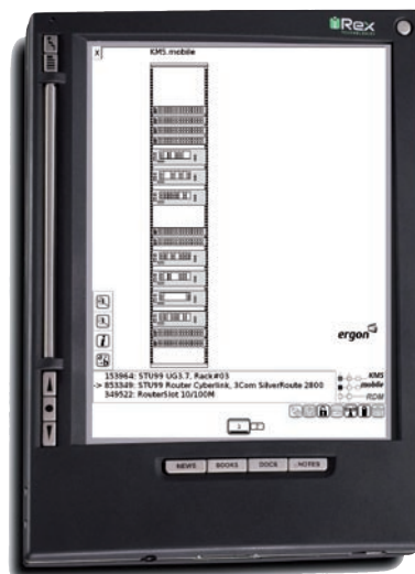
Abbildung 3: Mobiles Netzwerkmanagement, Schrankansicht
