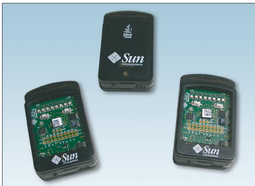
Bild 1 SunSpot-Devices: Spontan drahtlos vernetzte und mobile Java-Kleinstcomputer auf hohem Leistungsniveau.
